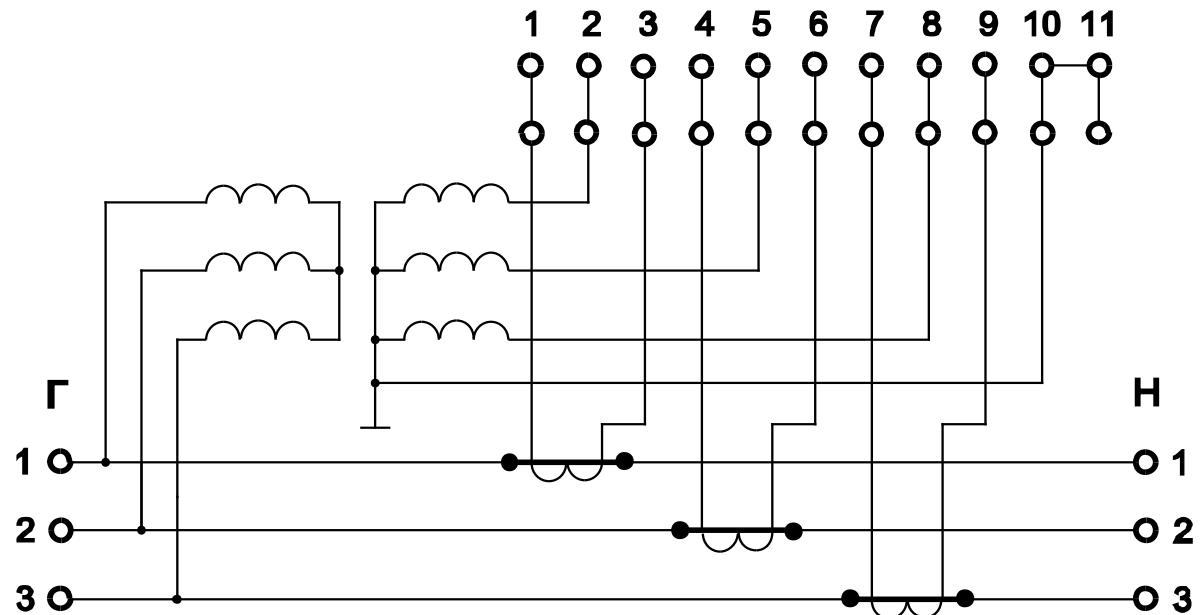
1.2. Схема включения счетчиков с номинальным напряжением 58/100В с тремя трансформаторами напряжения и двумя трансформаторами тока.
