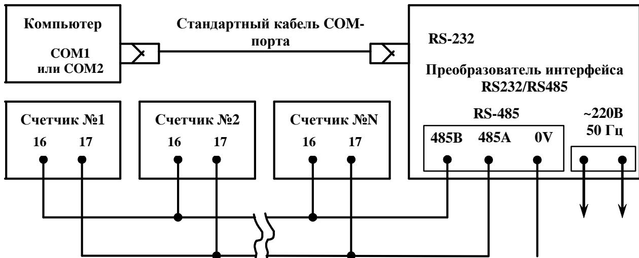
Рекомендации по организации канала связи между преобразователем интерфейса и счетчиками:
