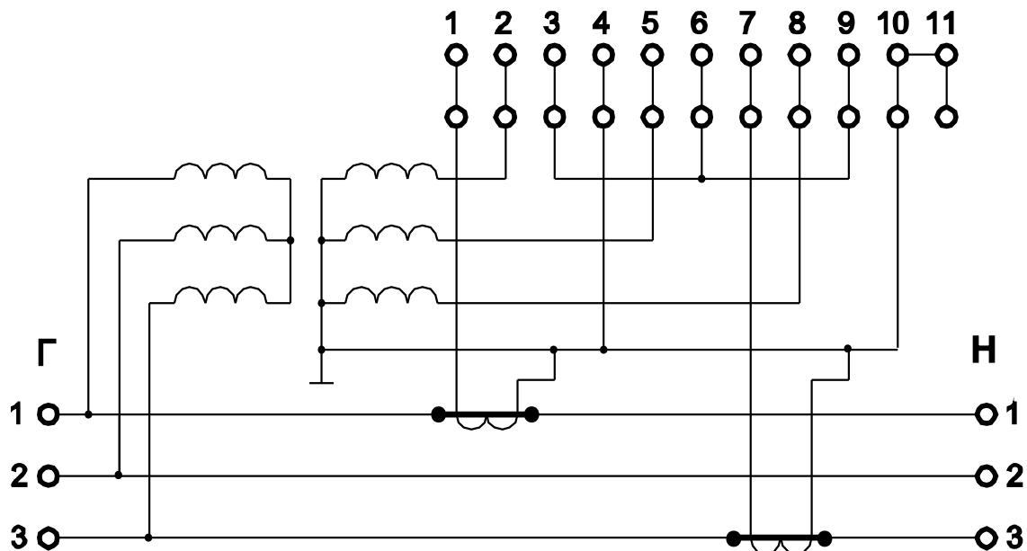
В зависимости от типа оборудования заземляется одна из фаз или общий вывод вторичной обмотки трансформатора.
